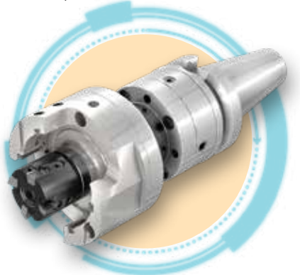
Herramienta combinada para escariado exterior con una plaquita ajustable de PCD, patines guía y una cabeza de fresado con cartuchos de PCD soldados.
